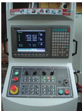
Le contrôleur sur base PC avec fonctions conversationnelles intègre un lecteur de disquette 1.44 Mb et liaison RS232 pour le transfert des programmes depuis une FAO.
