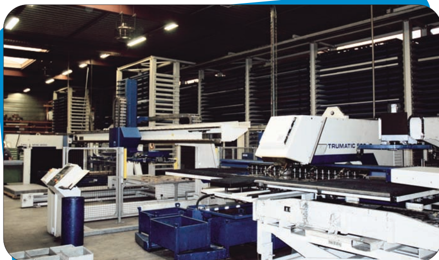
La société Viwametal est dotée de moyens de production performants. Ici, un système FMS composé d'un magasin central sur lequel sont connectées 2 machines de découpe laser et 2 poinçonneuses.
